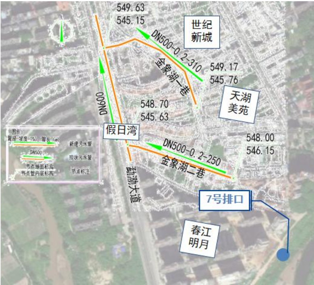
图 5.1.3-4 流沙河 7 号排口设计系统图
