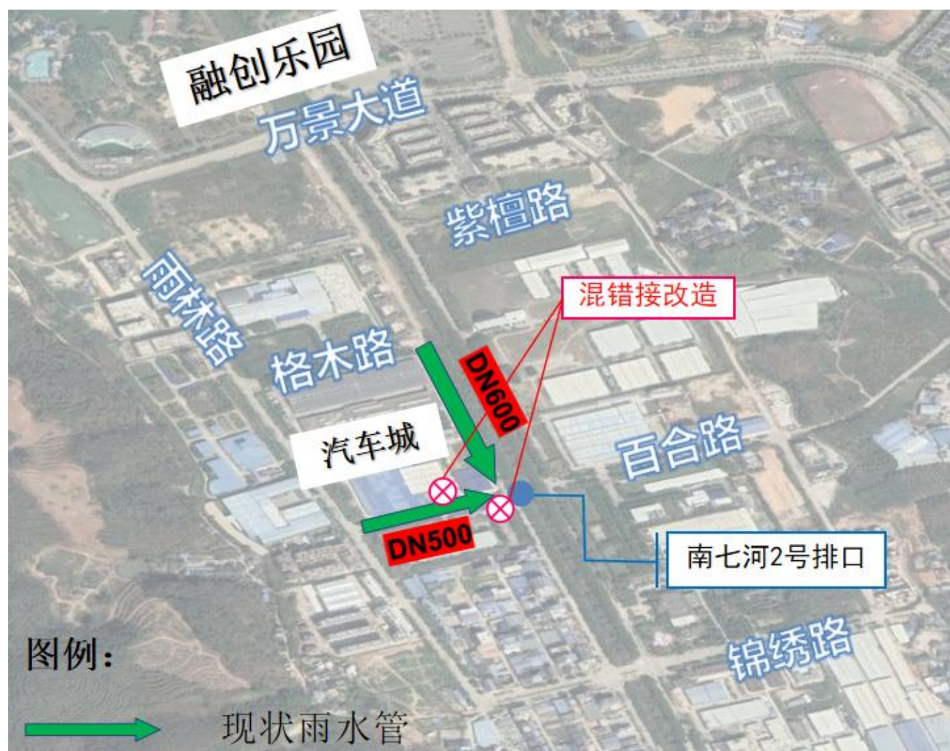
图 5.1.3-9 南七河 2 号排口设计系统图
