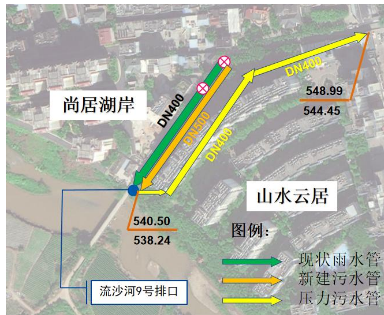
图 5.1.3-5 流沙河 9 号排口设计系统图
