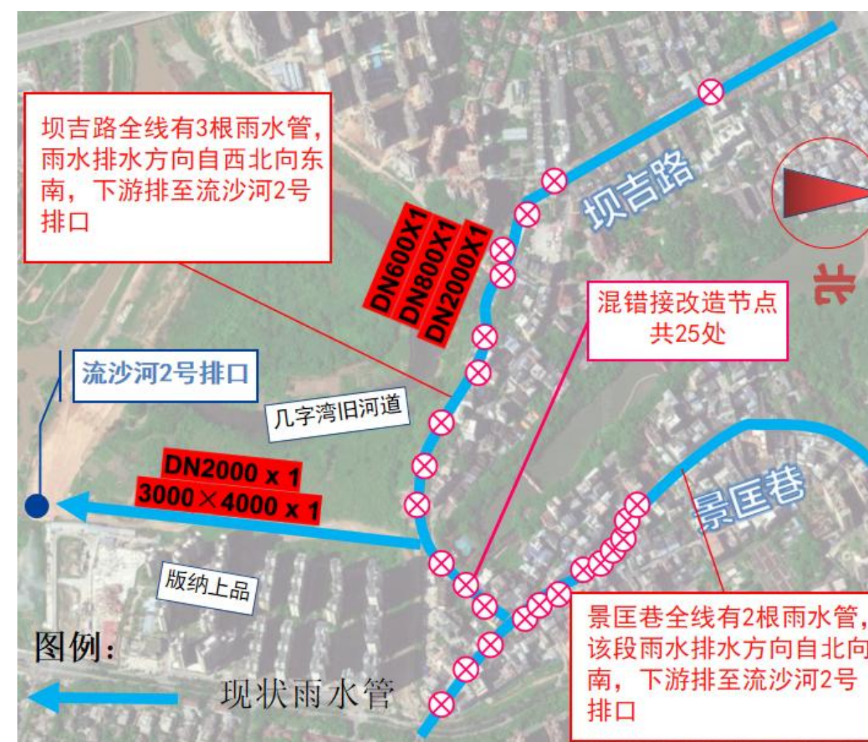
图 5.1.3-2 流沙河 2 号排口设计系统图
