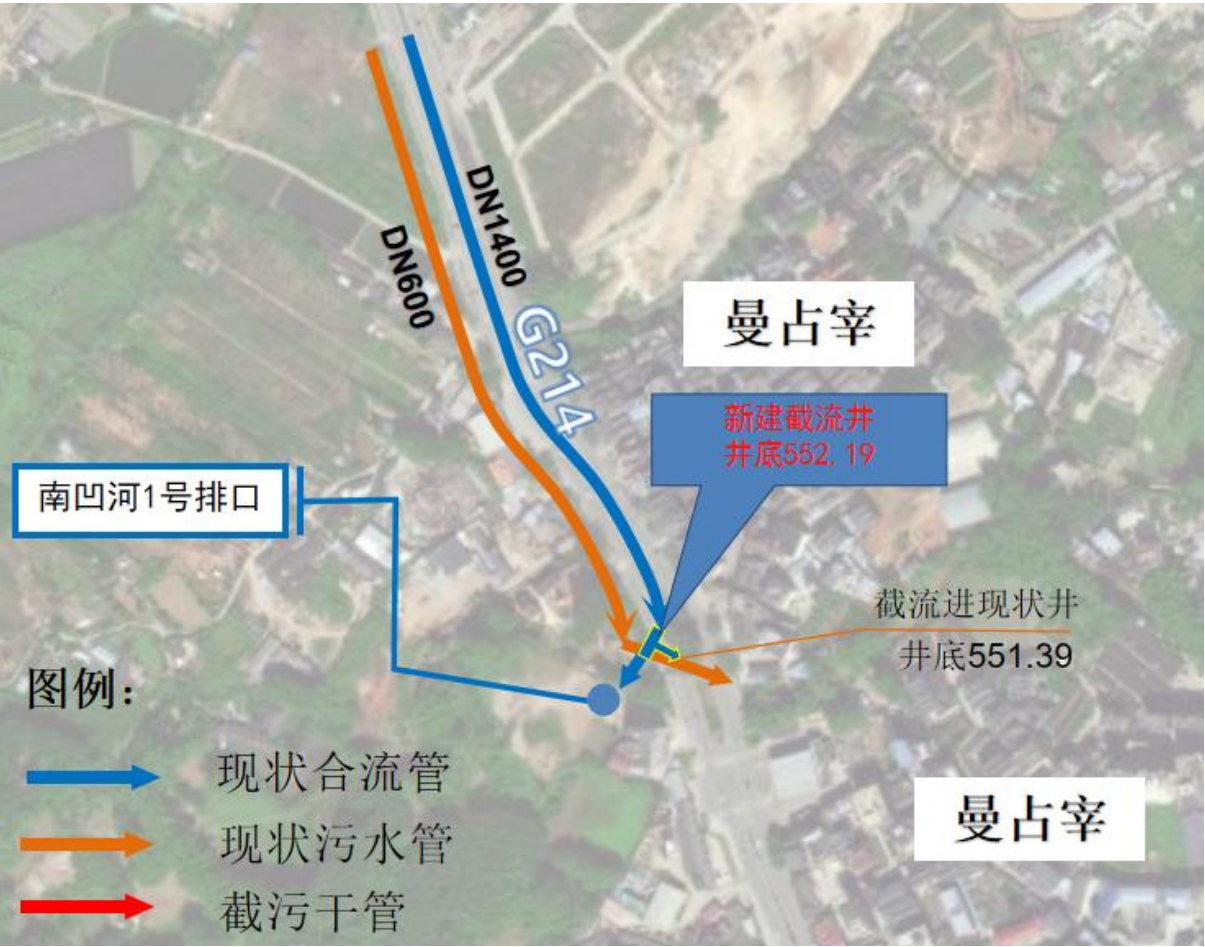
图 5.1.3-11 南凹河 1 号排口设计系统图
