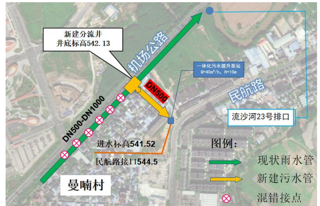
图 5.1.3-8 流沙河 23 号排口设计系统图
