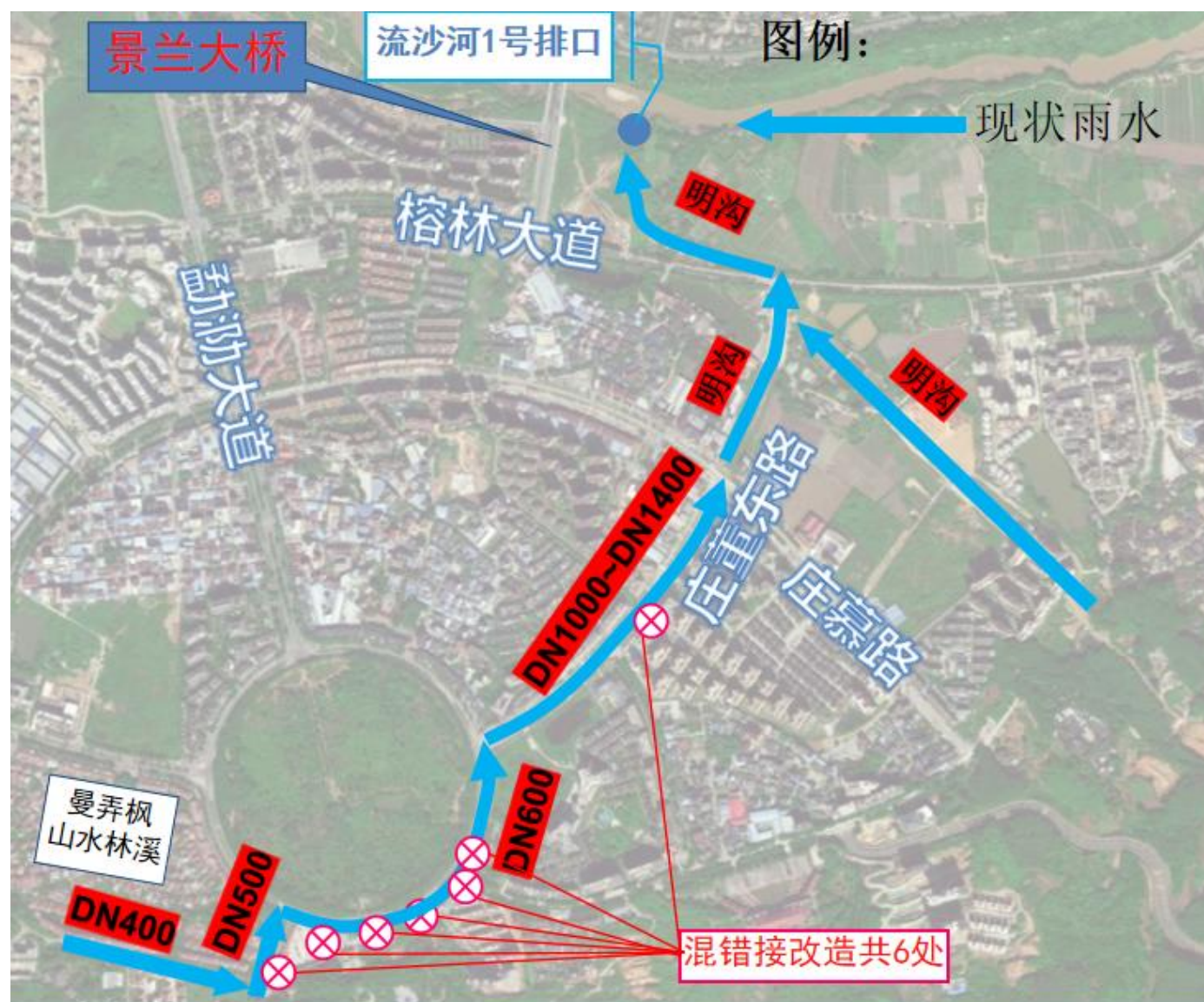
图 5.1.3-1 流沙河 1 号排口设计系统图
