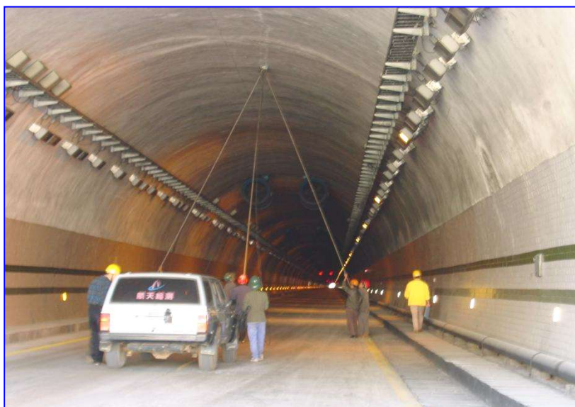
图 5-1.1.2-2 二次衬砌 900M 雷达检测
