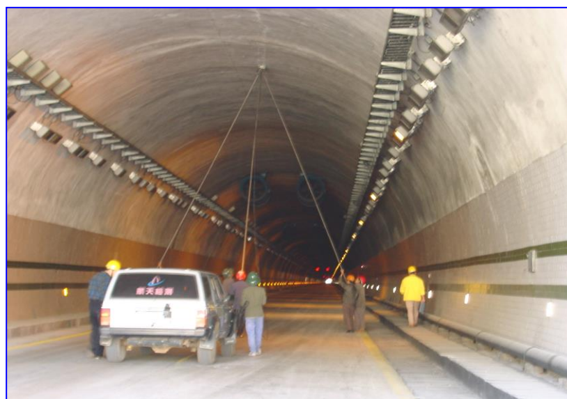
图 5-1.1.2-2 二次衬砌 900M 雷达检测
